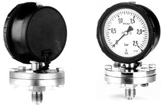
Прочная разделительная стенка между измерительной системой и пиферблатом, с откидывающейся задней стенкой и удерживающим ее пластмассовым ремешком. При разрушении чувствительного элемента задняя стенка корпуса откидывается назад.
